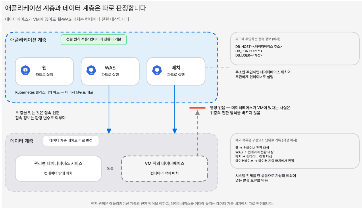
그림. 컨테이너로 전환하는 애플리케이션 계층과 따로 판정하는 데이터 계층의 배치 구분
